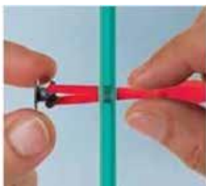
2) Mäkčenú podložku na ochranu vŕtania v skle jednoducho vložte do diery pomocou montážneho nástroja.
